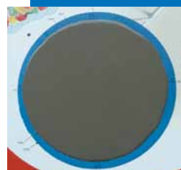
Contrôle de la fluidité avec une table à chocs
